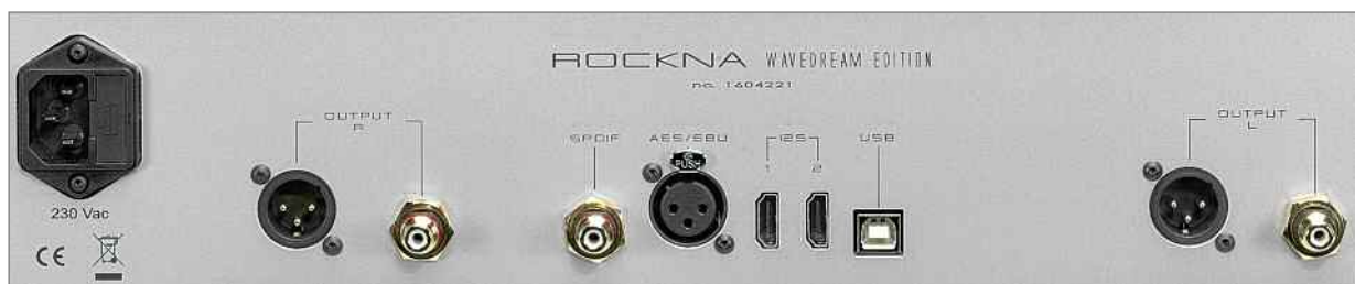
Die höchsten Datenraten (PCM in 32/384 und DSD256) nimmt der Wavedream nur über die beiden I2S-Schnittstellen sowie den USB-Eingang entgegen. Normale HD-Files (bis 24/192) auch über S/PDIF und AES/EBU
